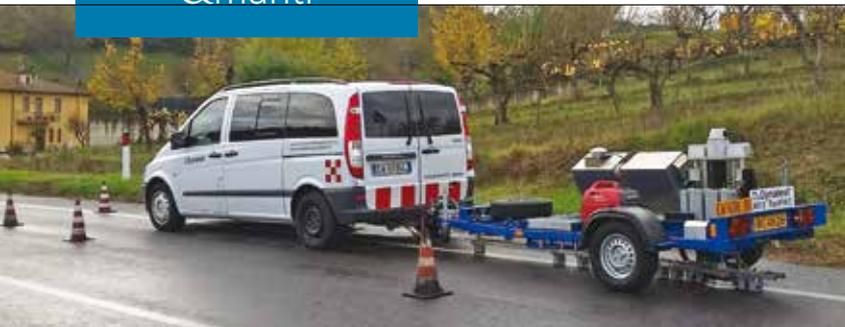
11. La strumentazione Falling Weight Deflectometer utilizzata durante le prove in situ
