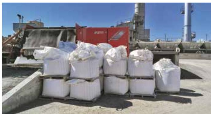
8. L'impianto mobile per il riciclaggio a freddo Wirtgen KMA 220 e big bag contenenti i mix di filler attivo premiscelati
