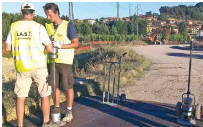
10. Le strumentazioni Light Weight Deflectometer utilizzate per le indagini prestazionali nel breve termine
