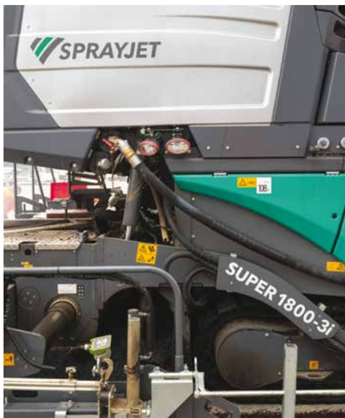
3. La Super 1800-3i Spray Jet è una finitrice cingolata dotata di uno speciale modulo-serbatoio che contiene emulsione bituminosa
